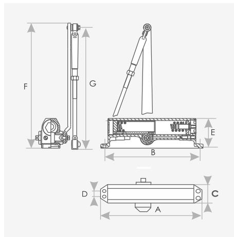
Точность зазора между поршнем и корпусом доводчика составляет 0.01 - 0.15 мм, что гарантирует изделию высокие эксплуатационные качества
